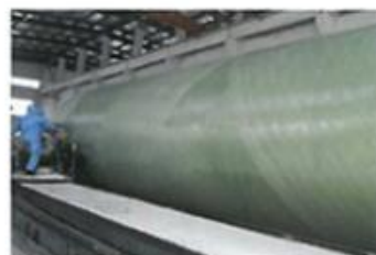
高强GRP筒体一次成型耐低温，耐高强腐蚀性
